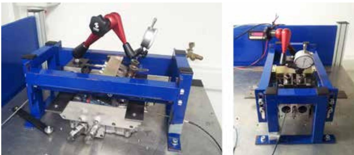
Abbildung 4.2 – Zylinderkopf auf Fließprüfstand
