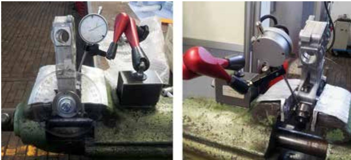
Abbildung 4.4 – Vermessung Nockenwellen
