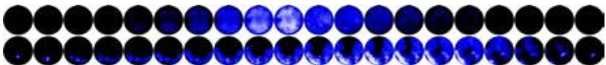
Abbildung 2.6 – Flammenausbreitung bei HCCI-Verbrennung und Flammenfrontverbrennung, nach [5]
